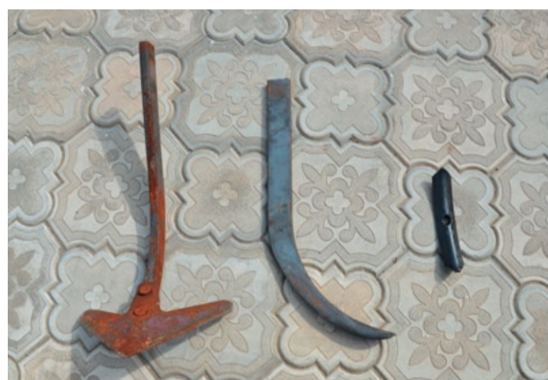
Слева направо: лапа культиватора КРНа в сборе; стойка от нее, используемая для рыхления тяжелых почв; чизель-наконечник
